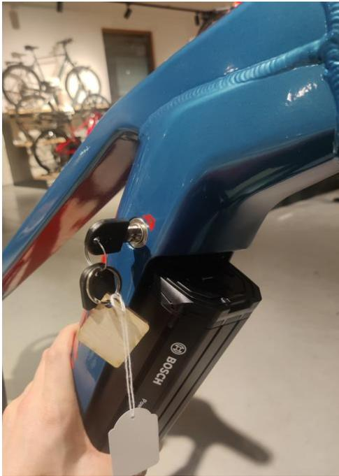
Replacer la batterie dans le socle inférieur
