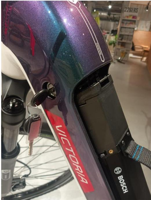
Replacer la batterie dans le socle inférieur
